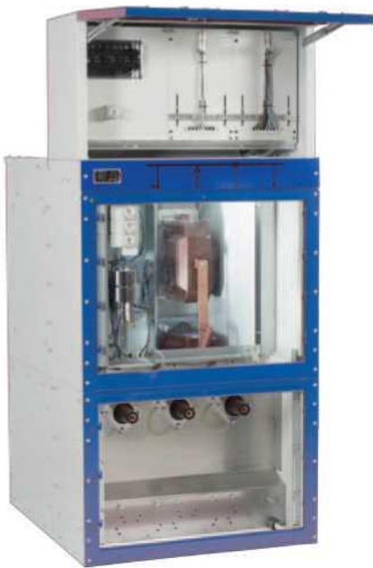
In via opzionale, è possibile prevedere un contenitore secondario per l'installazione di piastre di misurazione e strumenti di misura come voltmetri o amperometri, apparecchi di misura universali, ecc. (altezza totale A = 1900 mm).
