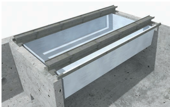
Trafostation mit hängend montierter Ölauffangwanne
